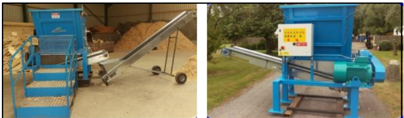
6 pav. Medinių palečių smulkinimo įrenginys
